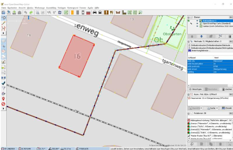
Du hast nun alle Tags markiert und kannst sie in das neue leere Objekt einfügen. Danach musst du nur noch die Hausnummer, die unterschiedlich ist, von Hand anpassen.
